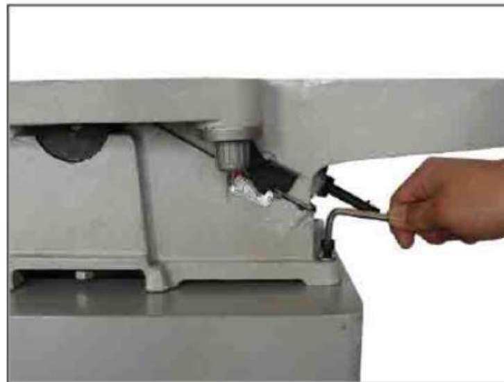
Рис. 4. Установка переднего крепёжного болта
