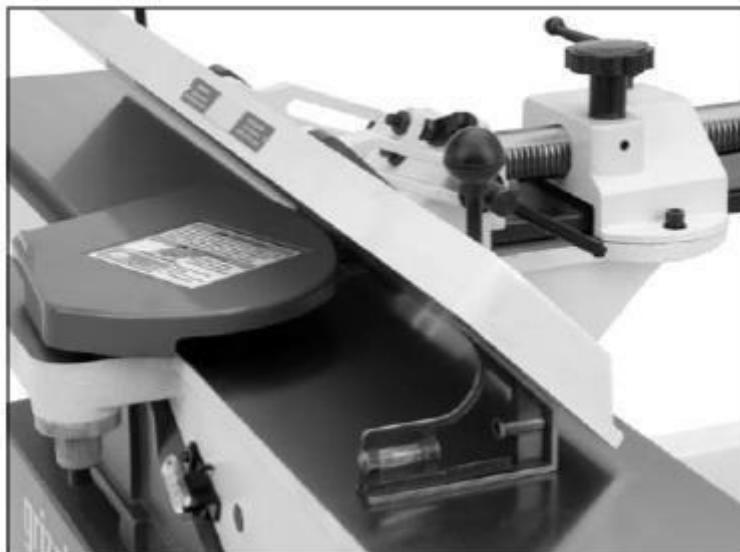
Рис. 24. Настройка под угол 45° внутрь
